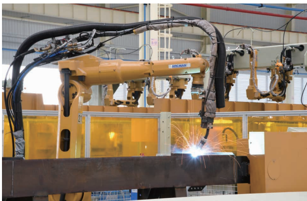
焊接機器人作業
