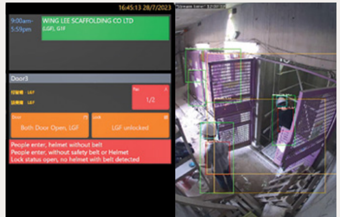
升降機槽採用具有自動警報功能的物聯網平台
