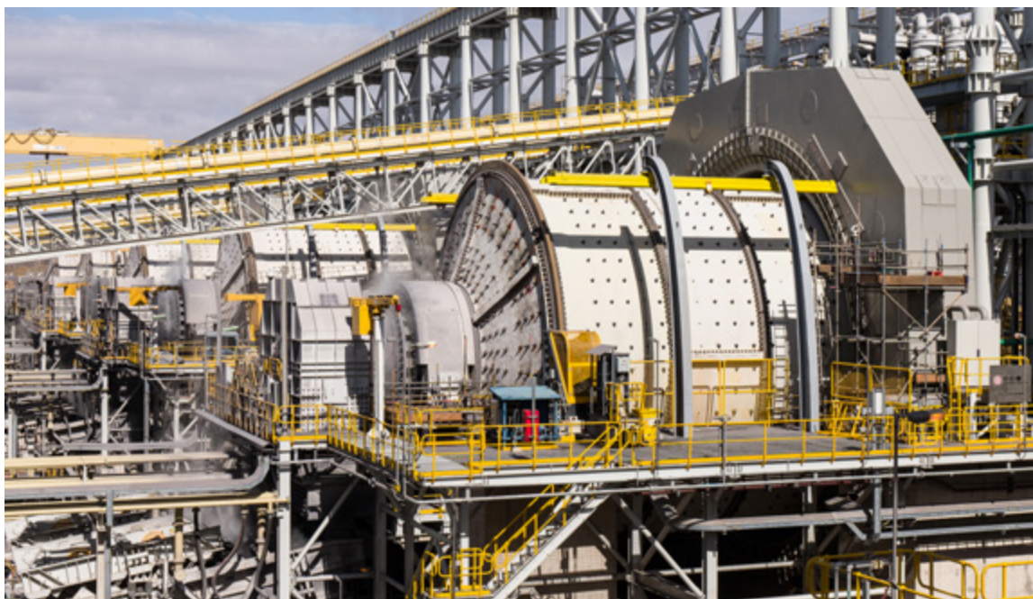
| \Phi 12.2\text{m} 大型高效智能化自磨機
