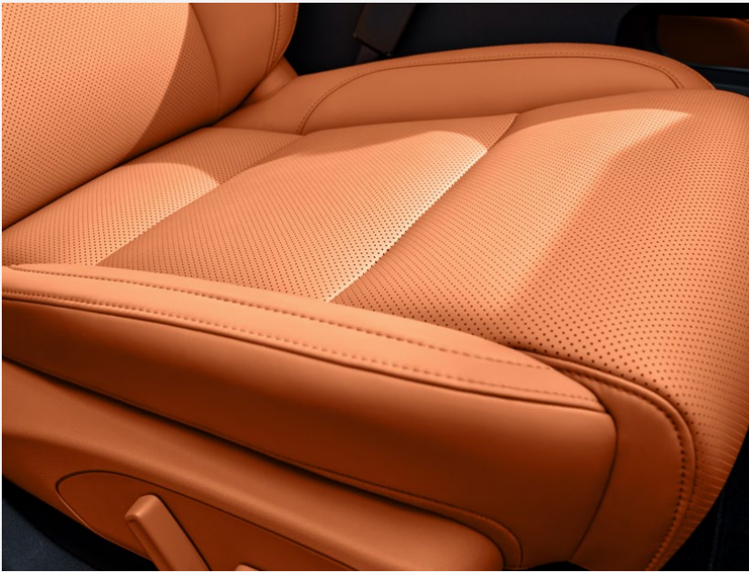
零跑 C10 座椅採用生物基大豆發泡材料
