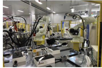
全自動前大燈塗膠、面罩扣合設備
