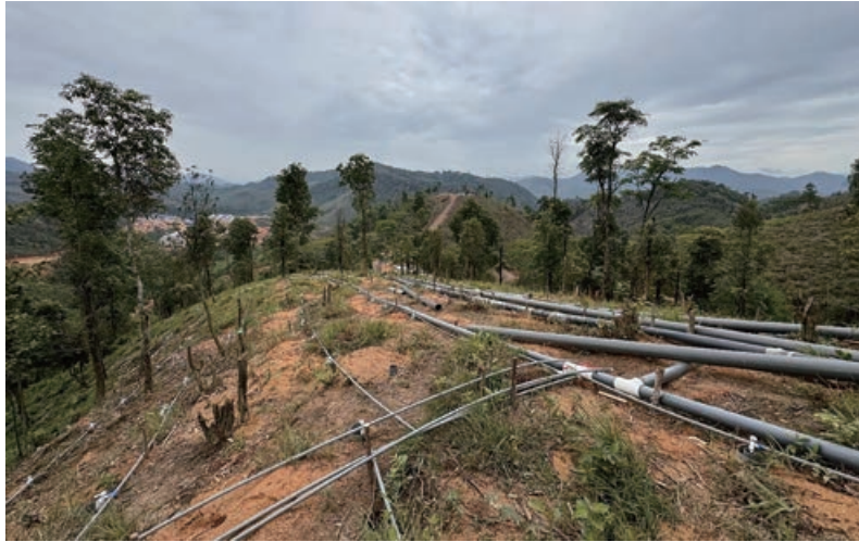
圖11-2：山頂的原地注液系統
