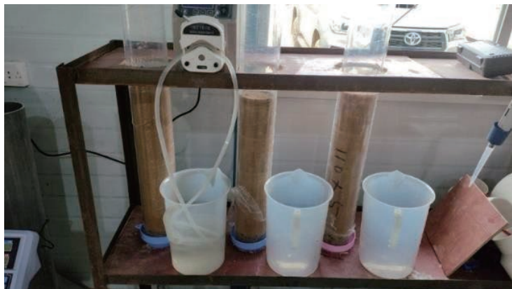
圖9-1：實驗室浸出試驗
