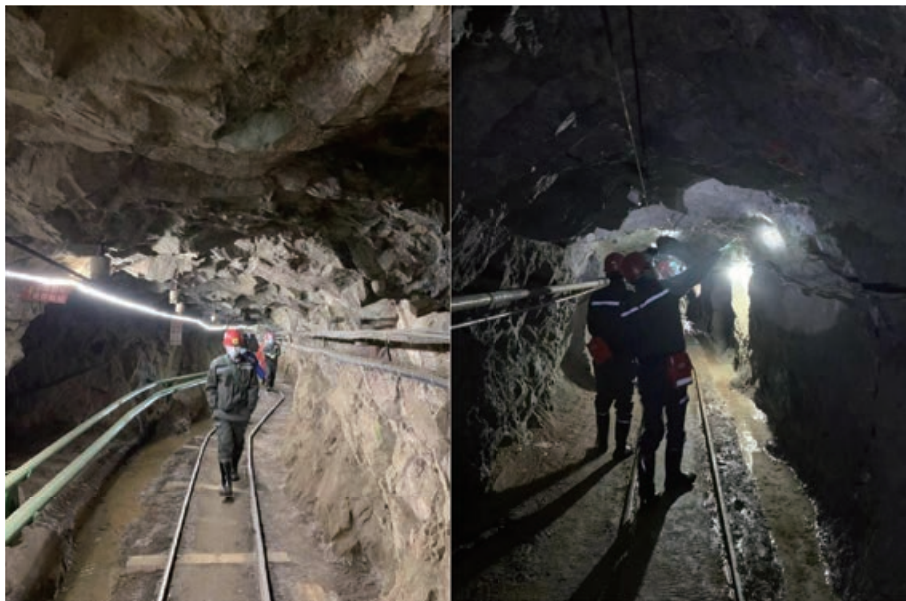
圖10-7：蓮花溝5號採區典型水平平巷及橫切平巷照片
