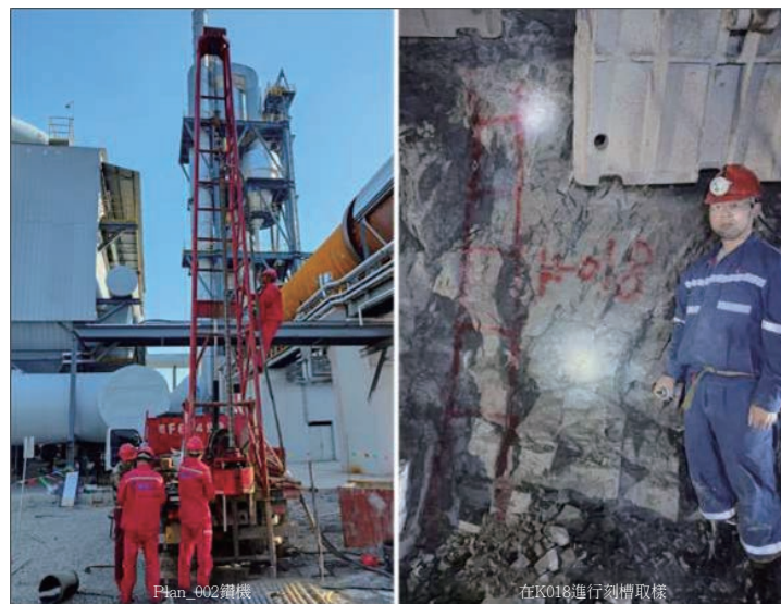
圖5.2：驗證鑽探與地下刻槽取樣
