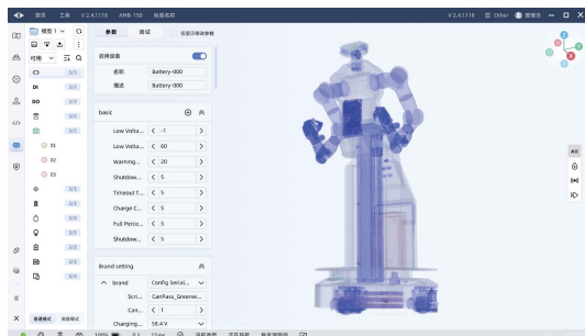
輪式人形機器人配置及控制界面
