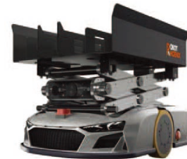
Squirrel-50 (料倉移動機器人； 最大負載：50公斤)
