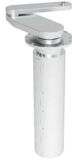
真空型磁流體密封 單臂機器人
