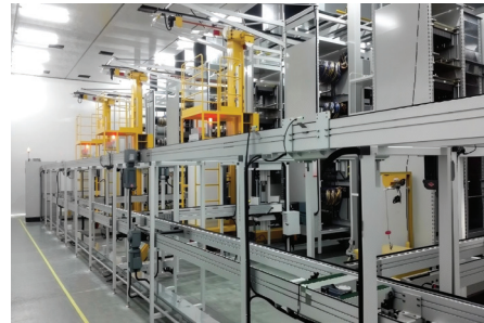
某鋰電池企業項目中應用的堆垛機
