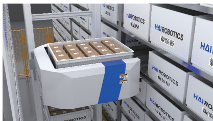
步驟1：提取貨箱（不移動整個貨架）
