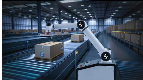
為因應這些挑戰，我們推出S系列協作型機器人，其額定負載為35公斤，工作半徑達1,800毫米，非常適用於飲食行業的標準包裝與碼垛作業。搭配升降柱使用時，碼垛高度最高可達2.2米。該系統碼垛週期可達每分鐘13次，單臂功耗僅1,000瓦。搭載自行研發的高效能馬達與震動抑制演算法，協作機器人即使在滿負荷狀態下仍能穩定運作。透過整合SkillBank碼垛流程套件，支援單／雙吸盤自動切換、雙線交錯碼垛、自訂堆疊樣式與流程數據追蹤。這些功能協助客戶滿足彈性生產需求，同時降低成本、提升效率。
