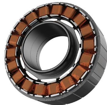
我們的無框力矩電機的主要特點包括：(i)通過優化磁極槽和磁路設計增強力矩，實現最大72Nm和18.7Nm／公斤，比國際同業高出約20%，(ii)利用高導熱環氧樹脂和先進的真空灌封技術實現優越的散熱性能，確保在更低溫度下更可靠的運行，(iii)採用槽幾何結構和繞線工藝實現低損耗和高效率，達到85%以上的槽填充率，降低了電阻並提高力矩輸出，及(iv)通過採用高精度自動化生產設備實現產品的高度一致性，保持小於1%的相間電阻和電感不平衡。
