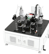
智能檢測及焊接機器人
