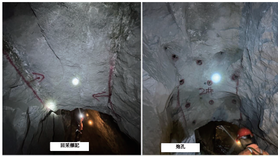
圖 16.8：回採管理與炮孔佈置
