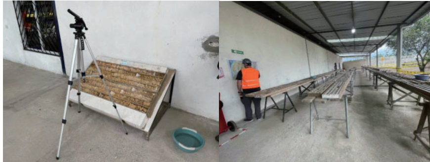
圖 11.1: El Domo 項目鑽探岩心照片和編錄
