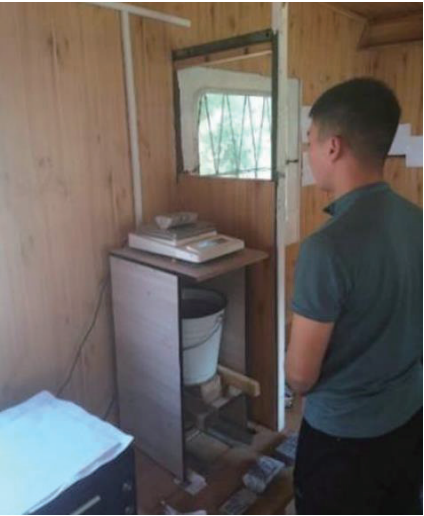
圖 11.4：2021 年克孜勒塔什岩心樣品的比重測量
