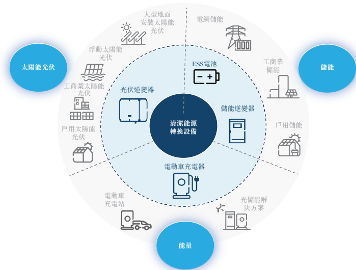
光伏發電轉換設備及應用場景
