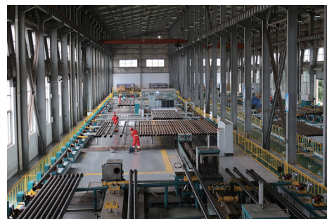
自動化鑽具檢測及維修車間
