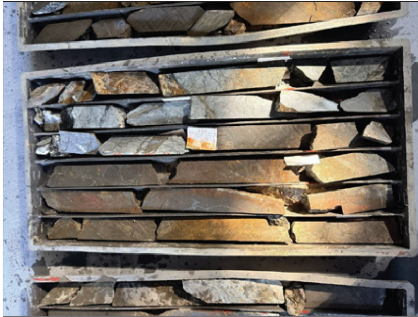
圖 5-4： 39 號勘探線 39G2637 號鑽孔 34.58–37.58 米處的銅—硫礦化
