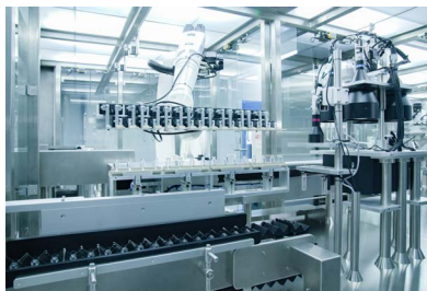
RTU生產線上的 自動機械搬運及在線檢測
