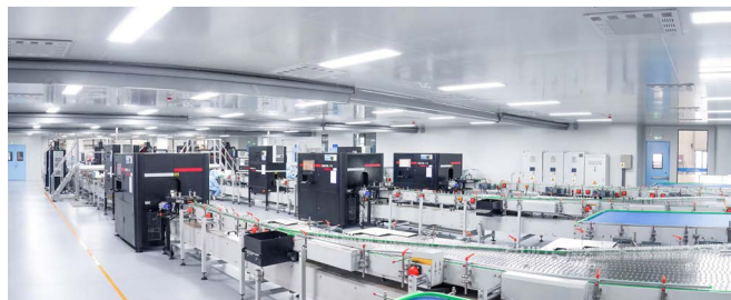
模製瓶的 自動人工智能視覺檢測
