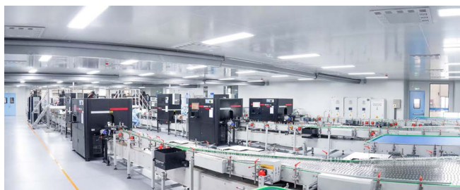
模製瓶的 自動人工智能視覺檢測
