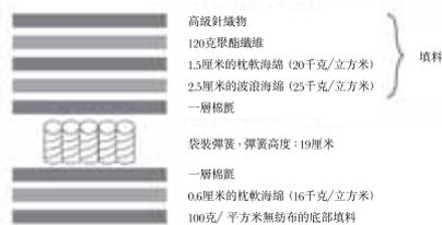
我們的袋裝彈簧床墊採用獨立袋裝彈簧裝配，經袋裝粘膠，打邊加工而成。獨立袋裝彈簧的內膽採用柱狀彈簧，外由無紡布包裹。
