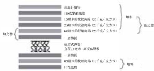
我們的連結式彈簧床墊採用拉絲提斯彈簧製造。拉絲提斯彈簧又稱一線鋼，由一根連續不斷的鋼絲交結而成，環環相扣。
