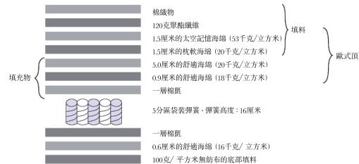
我們的分區床墊採用獨立袋裝彈簧裝配。獨立袋裝彈簧的內膽採用柱狀彈簧，外由無紡布包裹。分區床墊所用的線徑也不同，因此床墊各區軟硬度也不同。分區床墊優於袋裝彈簧床墊。
