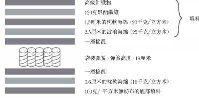
我們的袋裝彈簧床墊採用獨立袋裝彈簧裝配，經袋裝粘膠，打邊加工而成。獨立袋裝彈簧的內膽採用柱狀彈簧，外由無紡布包裹。
