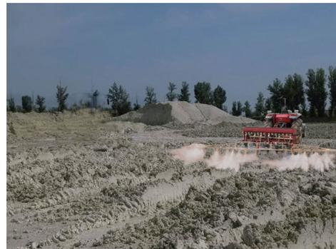
**陳化**－在堆放的膨潤土中添加柱撐助劑，置於室外堆放。堆積膨潤土的高度須超過一米。陳化過程將需90天左右，利用柱撐助劑將膨潤土的片層打開。
