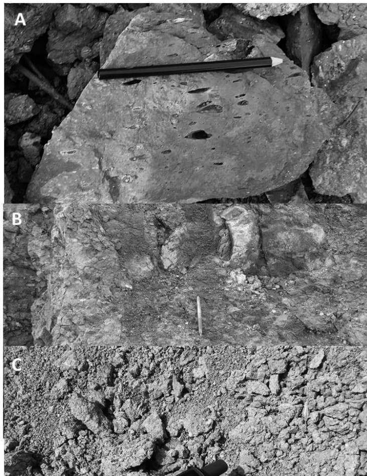
圖4-5： 蝕變成不同膨潤土類型 (B和C) 的安山凝灰岩 (A)
