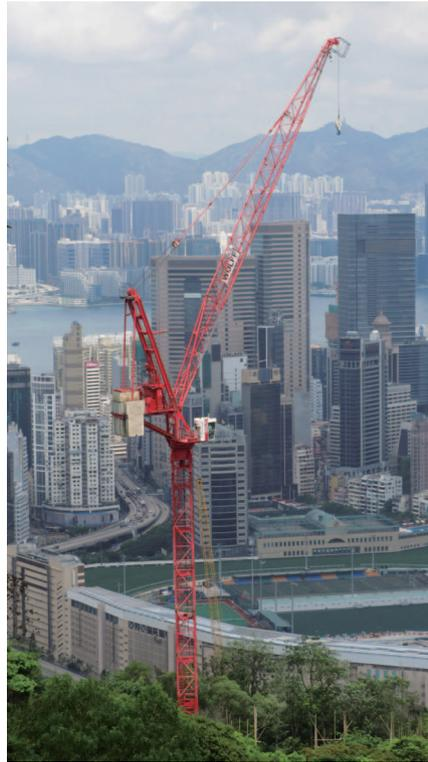
塔式起重機是通常固定在地面或附著在建築物側面的機械起重裝置。塔式起重機結合了高度、距離及起重能力並通常用於高層建築的施工。截至二零一五年及二零一六年三月三十一日止年度，我們共同擁有一台塔式起重機。本集團與一名獨立業務夥伴分別佔該共同擁有的塔式起重機50%權益。截至二零一六年八月三十一日止五個月，我們購入兩台塔式起重機，並於隨後直至最後實際可行日期內購入兩台塔式起重機。
