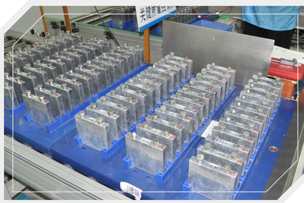
正在檢測電池及進行品質監控
