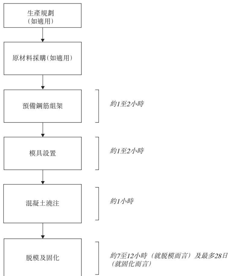
混凝土澆注至脫膜歷時約八小時，因為生產過程中使用的鋼筋組架及模具在該程序前已準備好。混凝土產品一經形成，初步固化程序隨即開始。進行脫模前，產品留在模具內固化約七小時。一經脫模，混凝土產品將固化7至28日。
