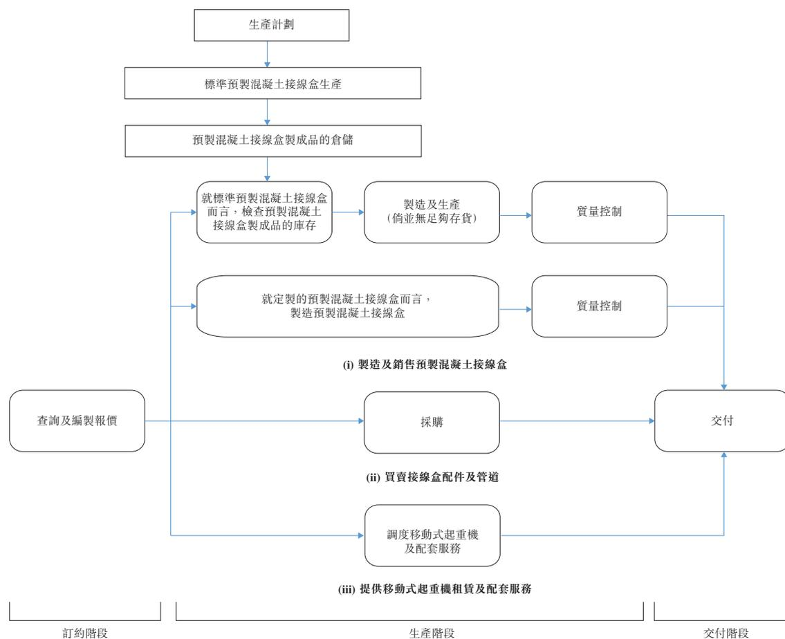
根據我們目前的商業模式，我們主要從事製造及銷售不同標準大小及尺寸的預製混凝土接線盒。收到客戶對我們標準預製混凝土接線盒報價的確認後，我們將核查我們有關製成品的庫存及安排交付預製混凝土接線盒予客戶。對於有關定製預製混凝土接線盒的查詢，我們將根據個別客戶的要求擬制定製的技術圖紙，然後才開始製造流程。我們透過公司內部的車輛或外聘物流服務供應商向客戶交付產品。為補充我們的製造及銷售預製混凝土接線盒業務，我們亦向客戶單獨或連同預製混凝土接線盒買賣接線盒配件及管道。
