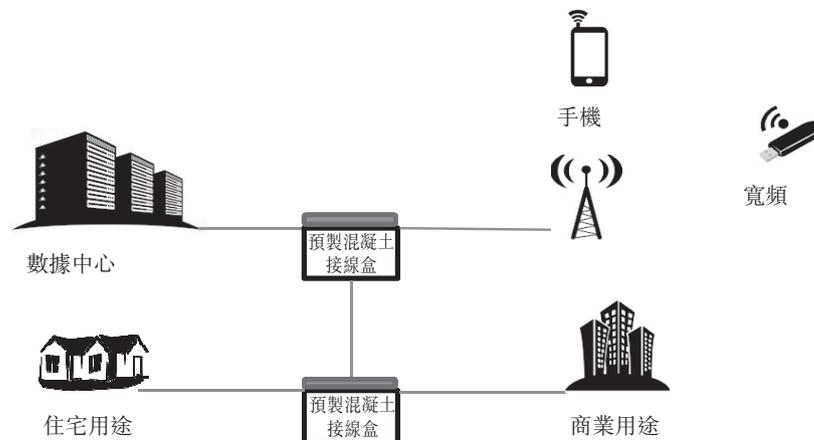
由於電纜容易受外在環境影響及需要預製混凝土電信接線盒在連接點提供保護，故預製混凝土電信接線盒廣泛用於電信服務提供。該等電信接線盒於導管系統中作為中間連接及接合點。
