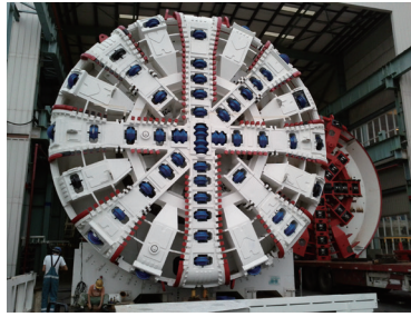
隧道掘進機刀盤(附註)
