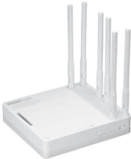
Wi-Fi速率高達1.9Gbps，同時可在5GHz頻段及2.4GHz頻段分別以1.3 Gbps及600 Mbps速度工作。六條高增益天線及五個千兆以太網端口。
