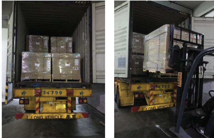
貨物在裝上飛機或船舶前會併合在一個集裝設備。貨盤運輸為貨物在一個稱為貨盤的扁平運輸結構（通常為木板）上併合的程序，旨在加快堆疊貨物的機械搬運。一般機械設備（如叉式起重車）其後可輕易搬運標準化貨盤運輸貨物，以在倉庫中移動或裝運至飛機上的集裝設備或船舶內的集裝箱作貨運之用。
