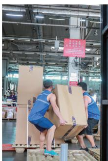
本集團提供打板服務，即將物品綑綁在稱為貨盤的扁平運輸結構（一般為木板）上的過程以協助機械式處理堆疊貨品。透過將貨品打板，我們的員工可以使用機械設備（例如叉車）在空運貨站裡移動物品或將物品移動至集裝設備上。在安排呎吋相近的包裹放在一個貨盤上前，我們的員工會先檢查包裹的狀況，以善用貨盤載量。打板後，我們會使用塑料薄膜以保護並固定堆疊貨品。經處理的集裝設備將根據客戶指定的送貨地點分揀，以便送貨。
