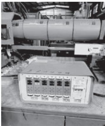
於原材料混合物放入注塑成型機後，生產人員隨後確認注塑成型機的設置，確保成型機器正常運轉及按適當溫度熔化原材料混合物。
