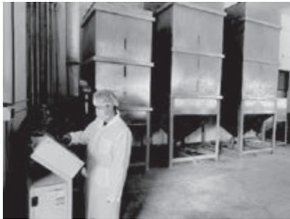
我們的生產人員按照預定的產品規格將聚丙烯樹脂、色劑及聚合物等原材料混合。其後，混合物將投入中央供料系統，而中央供料系統通過連接器將混合物投入注塑成型機。放入後，我們將目測原材料混合物是否按產品規格妥為放入。
