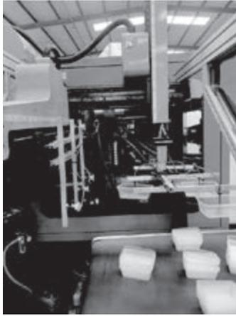
於該階段，已安裝在注塑成型機的模具將閉合，之後向模腔注入經熔化的原材料混合物。模腔注滿後，成型產品須充分冷卻。產品冷卻後，模具打開，彈出產品。
