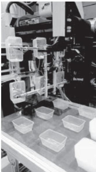
其後，自動化機械手撿起彈出的成型產品。該過程持續重複，直至全部產品根據客戶訂購的協定數量妥當塑型。自動化機器人機械手會按照預定設置成批置放成型產品，讓生產人員可收集全部產品以供包裝及交付。
