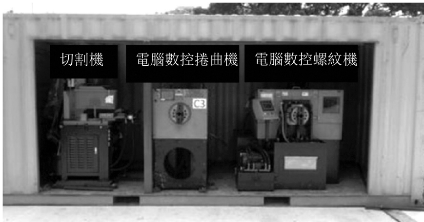
位於車間的三種機械鋼筋並接機
