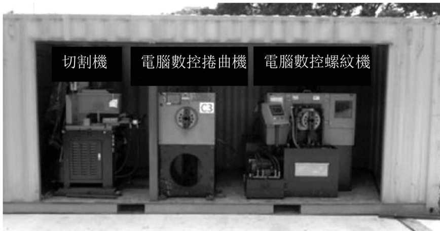
位於車間的三種機械鋼筋並接機
