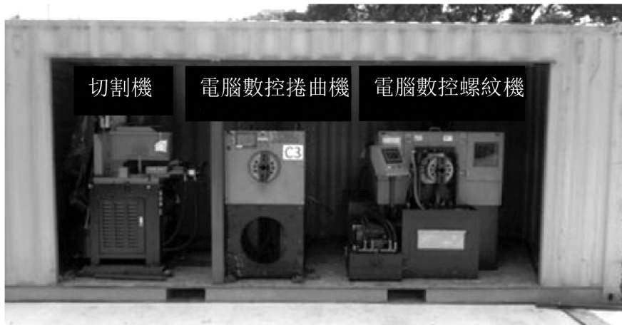
位於車間的三種機械鋼筋並接機
