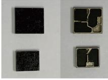
• SiP(系統級封裝)客製化設計外殼採用液晶聚合物材料，為一種用於吸收射頻及保護IC裝置免受物理損壞的外殼。
