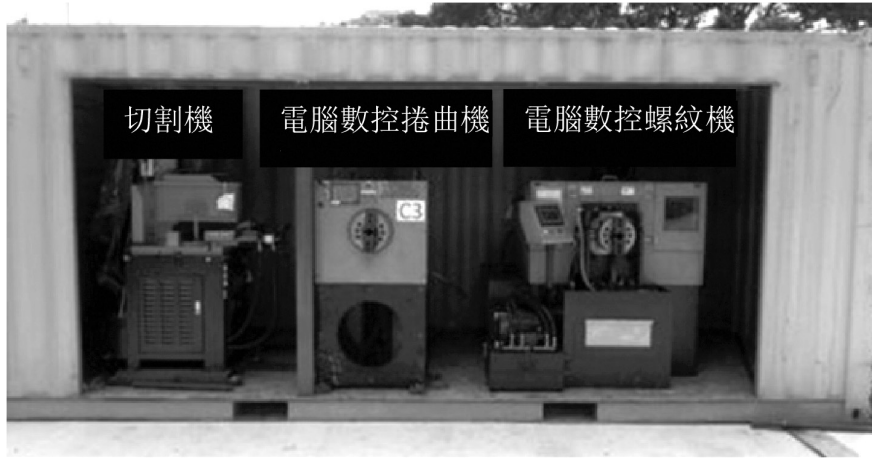
位於車間的三種機械鋼筋並接機
