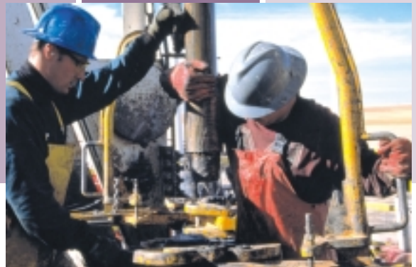
兩名油井修建工人正在一個勘探石油鑽井上準備一支新的鑽桿。
