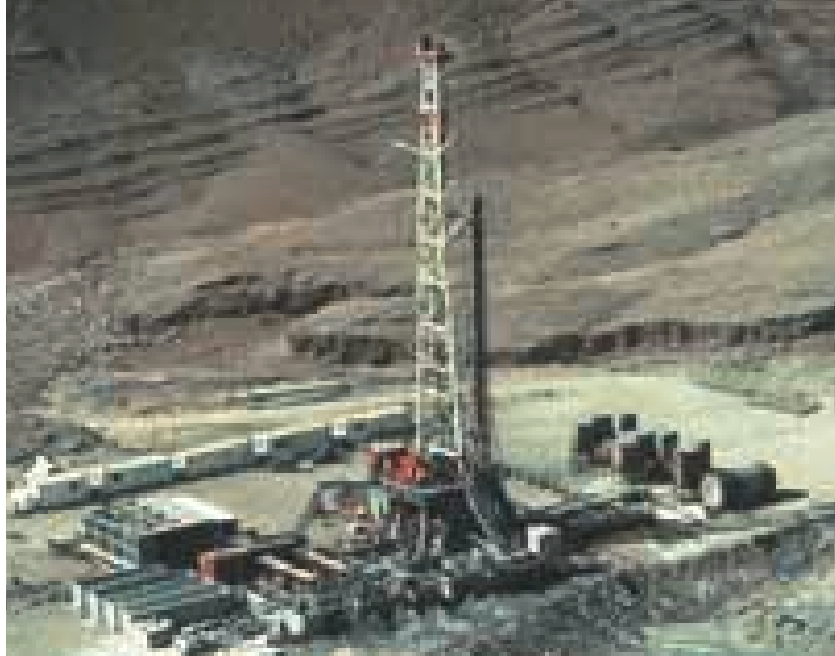
陸用油田鉗機利用卡特彼勒 3512 型號發電機驅動。
