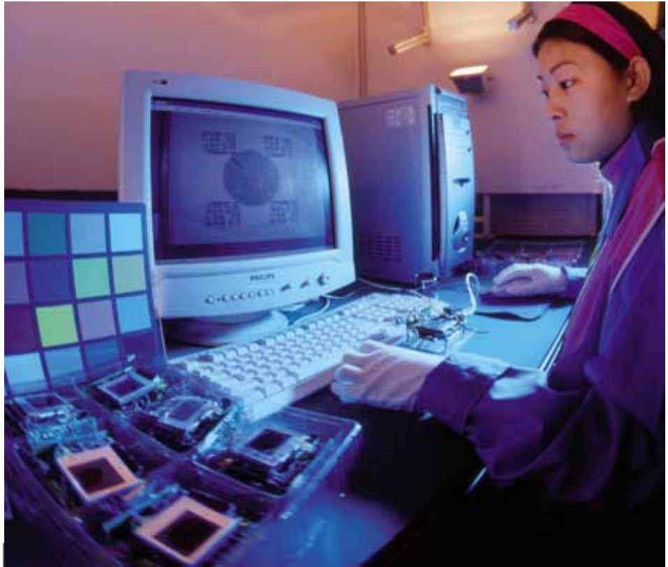
和記港陸的一名技術員正在調校數碼相機中之精密配件CMOS感應器。
