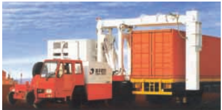
建聯工程分銷之「同方威視」車載移動式集裝箱檢查系統
