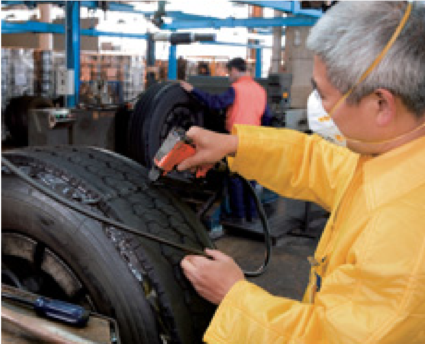
屯門車廠的輪胎翻新設施
