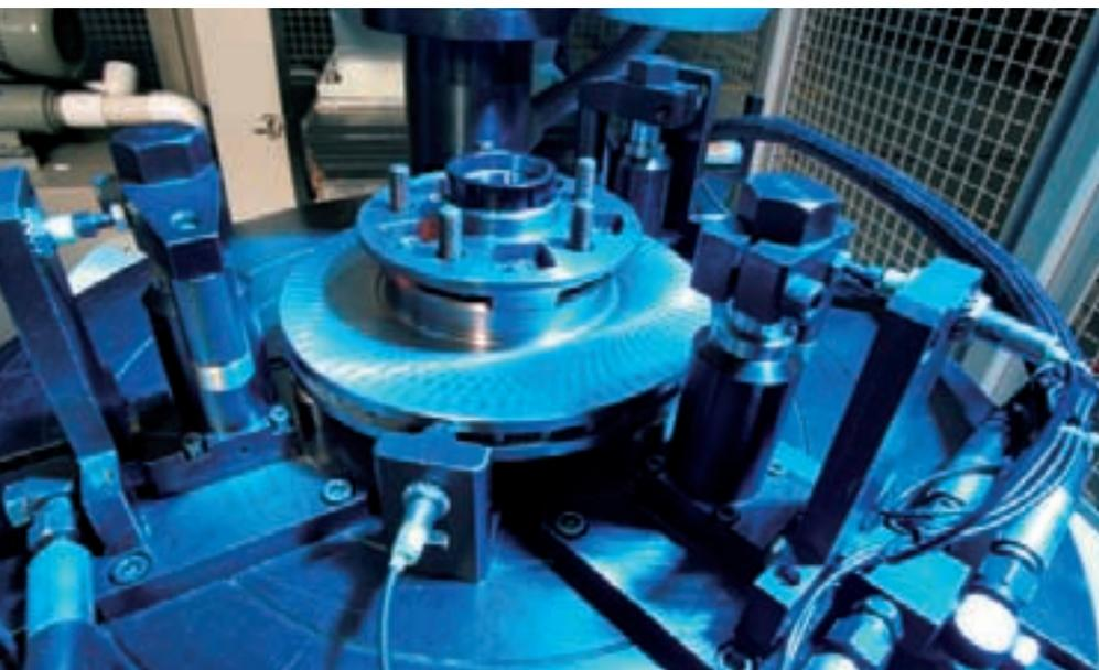
前輪殼合件動平衡檢測設備
