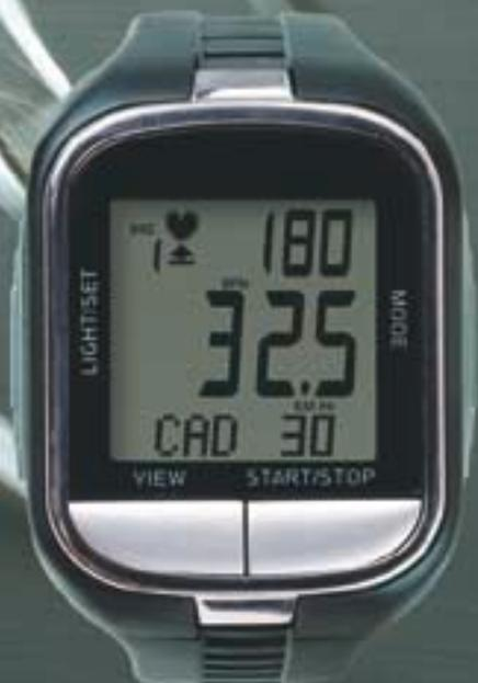
單車心率監察儀 (HRM) 系統監察心跳速率、速度、頻率、平均速度、最高速度、距離等。三個無線感應傳送器(兩個裝置於單車，另一個緊貼於車手胸前)與展示接收資訊之手腕上手錶交流訊息。
