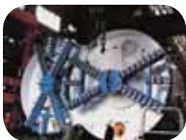
6.52米雙圓隧道掘進機
