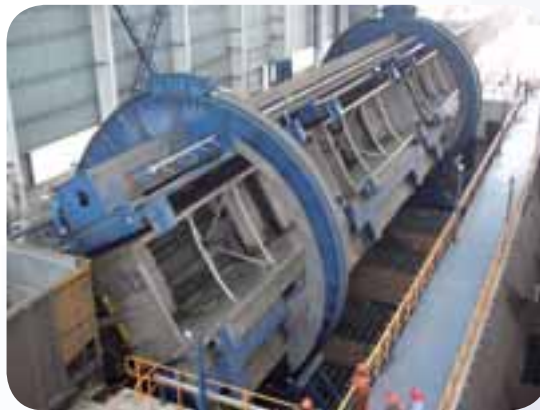
振華港機(ZPMC)研製的可實現「一次三翻」的翻車機系統
