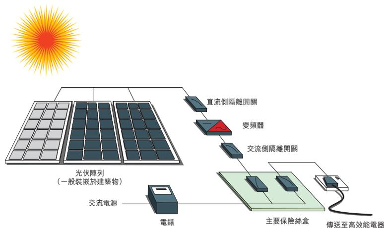
光伏系統適用於聯網市場以及無法實質與一般電力傳送網絡連接或與電網連接在經濟上並不可行的離網工業及住宅市場。市面上最常見的光伏電池基板為硅晶體，包括單晶硅及多晶硅。
