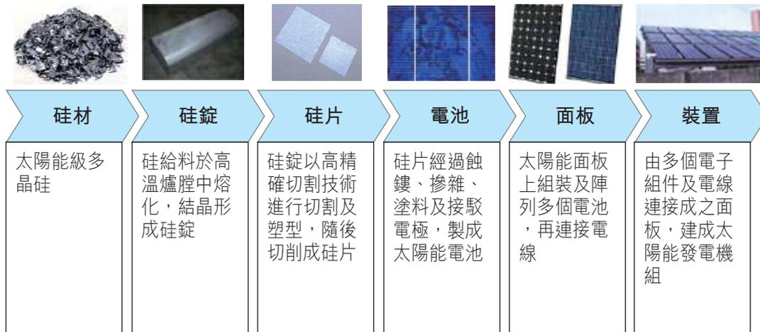
自硅錠之棄置部分、鍋底料及硅片碎片中抽取之回收硅材，亦可用於硅錠結晶的工序。
