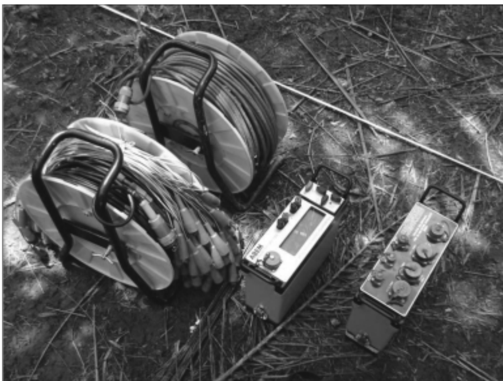
圖17：地電阻率成像測量所用工具。
