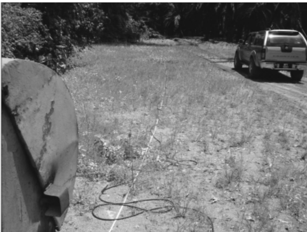
圖18：佈於北山附近的地球物理導線的地震檢波器。
