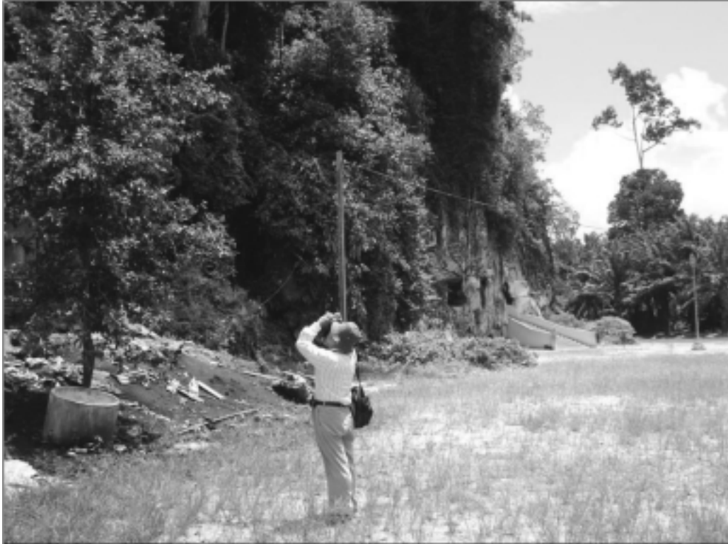
圖19：採用激光雙筒望遠鏡測量高度以評估儲量。
